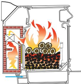
Les arrivées d'air primaire et secondaires sont réglées de façon à obtenir le dégagement de chaleur souhaitée. La combustion secondaire se poursuit dans le catalyseur.
