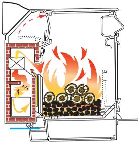
Recharger en bois et régler l'arrivée d'air primaire de façon à obtenir la combustion désirée. Dès que la température atteint 260 °C, fermer le clapet d'évacuation des fumées. La combustion secondaire catalytique est activée, les gaz brûlent à travers le catalyseur.
