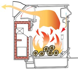
Le clapet est ouvert, le thermostat est réglé de façon à permettre l'arrivée d'une grande quantité d'air. Il faut laisser chauffer le poêle, avec un bon lit de braises, jusqu'à obtenir une température de plus de 260 °C.
