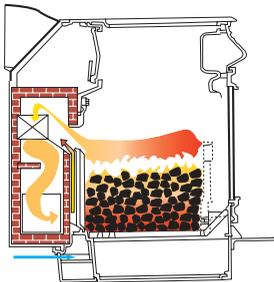
La combustion des gaz volatils est quasi complète. Le dégagement de chaleur se poursuit de façon constante pendant plusieurs heures. Dès que le lit de braises diminue, ouvrir le clapet d'évacuation des fumées avant de recharger le bois.
